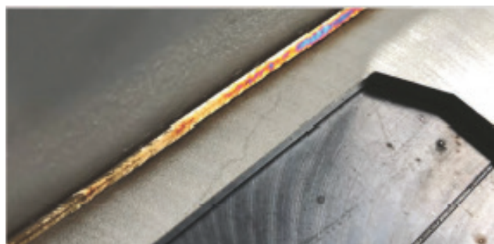
Koutový svar - materiál nerez 3 mm
