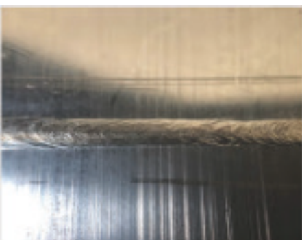
Svar natupo - materiál hliník 2,5 mm
