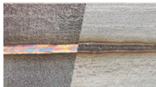
Svar natupo - materiál nerez 3 mm I kořen
