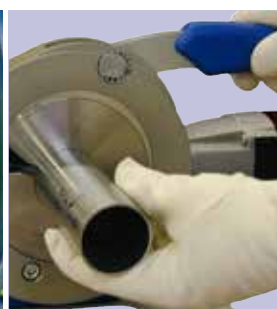
Schnellwechselsystem für Werkzeuge, Spannschalen und Rohre
