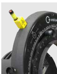
Integrierter Strichlaser zur Trennstellen-Markierung auf dem Rohr
