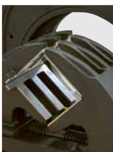
Inklusive Stahlgleitspannbacken mit Edelstahlspannaufsätzen
