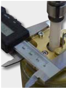
Einfache und präzise Einstellung der Elektrodenposition
