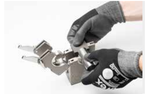
Eine an die Spannkassette befestigte und dadurch unverlierbare Rohrmittenlehre stellt die exakte Positionierung des zu verschweißenden Rohrstoßes sicher.
