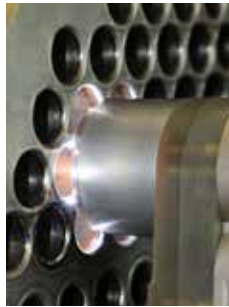
Hochwertige Ergebnisse an horizontalen oder vertikalen Rohrböden
