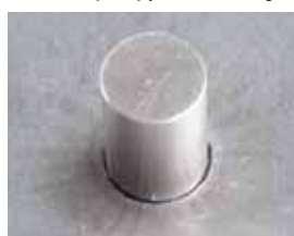
12 mm otvor vyřezaný pomocí technologie True Hole
