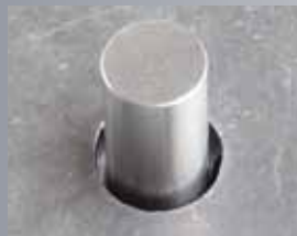
12 mm otvor vyřezaný bez použití technologie True Hole
