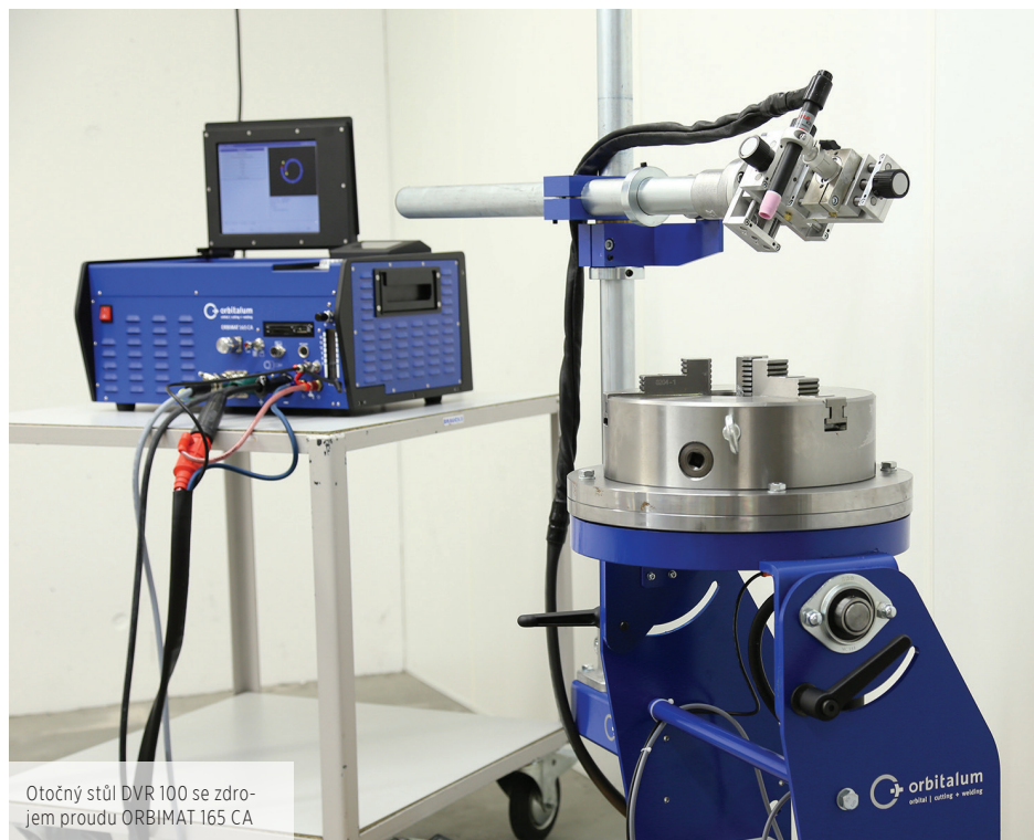
Tříčelistové sklíčidlo pro přesné polohování a fixaci svařenců
