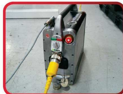
Řízený zdroj je kompaktní a přenosný. Obsahuje zabezpečení a označení zařízení při údržbě. Ovládací prvky má na horní straně.
