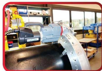
Systém elektrického pohonu EPD je určen pro stroje LCSF s vnějším upínáním a pro stroj EP 424 s vnitřním upínáním
